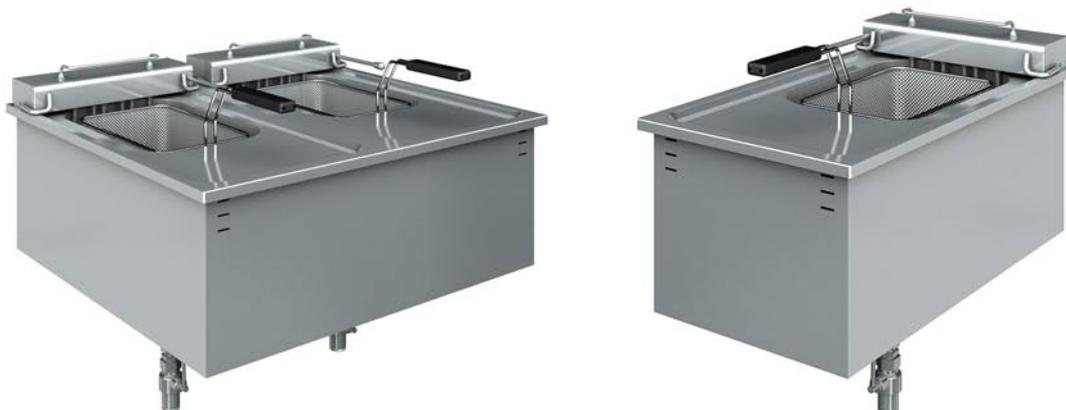
Friggitrice elettrica da incasso, dotata di sistema di riscaldamento con gruppo di resistenze sollevabile, provvisto di blocco di sicurezza in posizione sollevata. Struttura realizzata in acciaio inox AISI 304. Vasca stampata in acciaio inox con spigoli arrotondati e zona fredda. Valvola di scarico olio posizionata sotto la vasca. Regolazione della temperatura da 50°C a 190°C tramite termostato, limitatore di surriscaldamento. In dotazione: un cestello ed un coperchio per ogni vasca.
